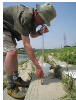
写真 124 No.29 地点 逢妻川 7K0 付近 同上、透視度測定
